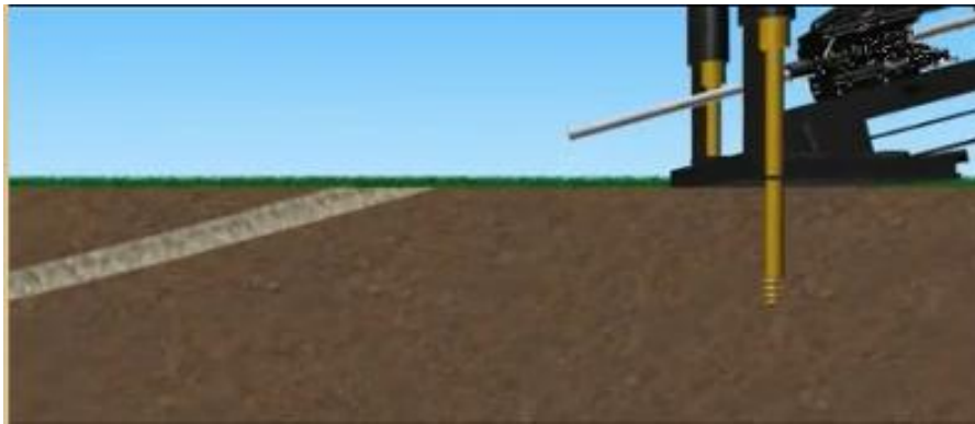
图 2-8 反向拖拉管材示意图
